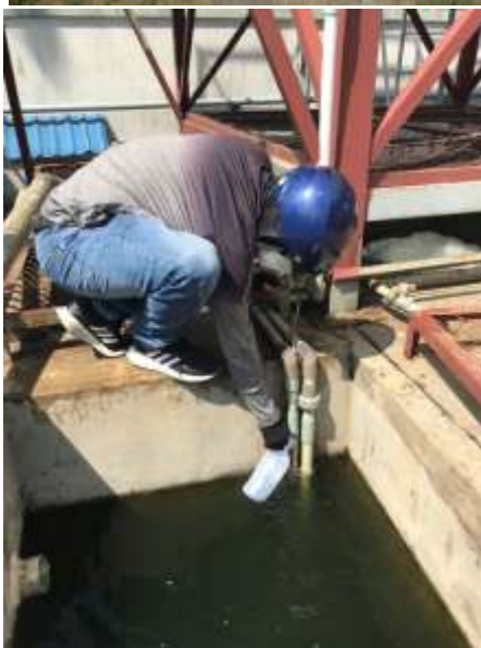
Hình 19.3: Công tác lấy mẫu nước mặt và nước thải
