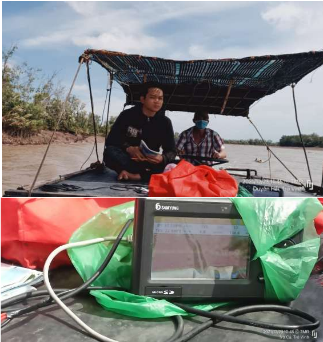
Hình 19.1: Công tác đo đạc mặt cắt sông, kênh
